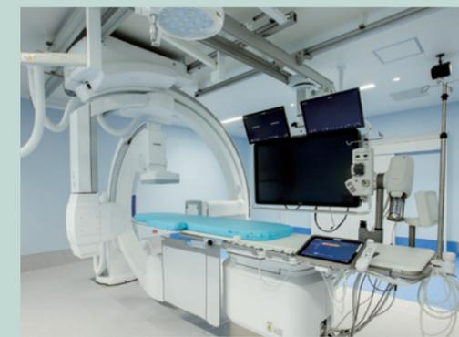
循環器領域専用血管造影X線診断装置。2方向同時撮影(バイプレーン機能)でより鮮明な映像を使い検査や治療を行います。
